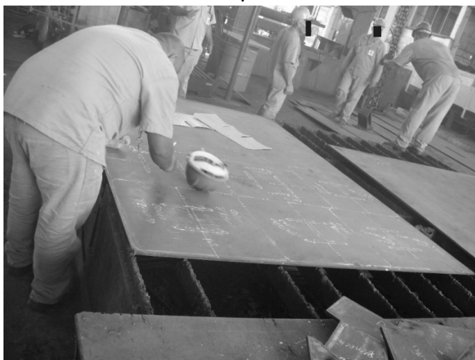
Figura 1 – Riscador Realizando os Riscos na Chapa
