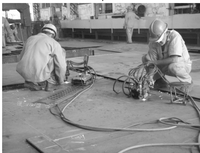
Figura 2 – Maçariqueiros Efetuando Corte de Chapas com a Máquina “Tartaruga”
