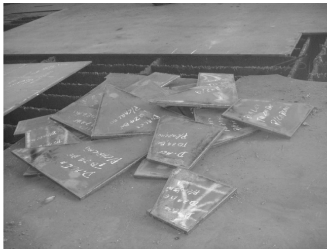
Figura 3 – Peças cortadas para posterior “encaixe” na embarcação.
