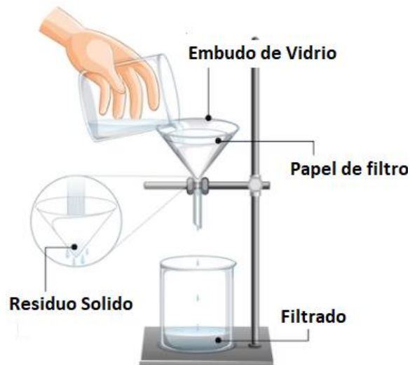
Fig. 8 Ejemplo de Filtración
